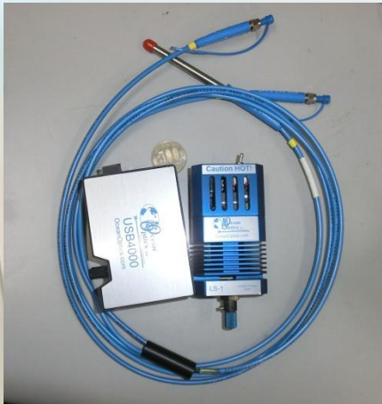
小型分光光度計を用いた簡易反射率計
