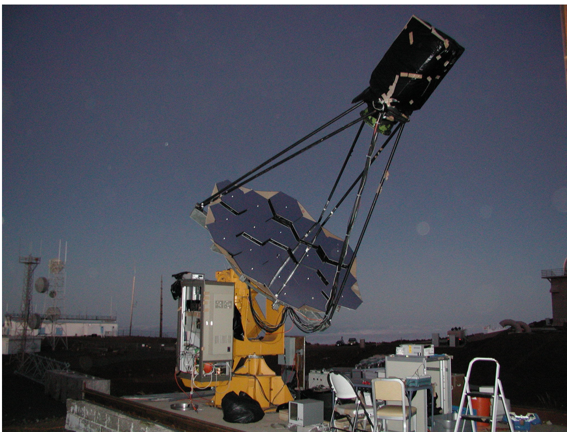
図 4.1: Haleakala 山頂に設置された Ashra TeV- \gamma 線用の試作経緯台式望遠鏡
