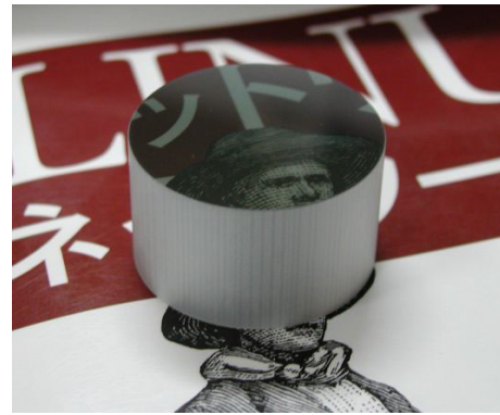
図 7.4: FOP によって画像が伝送される様子
