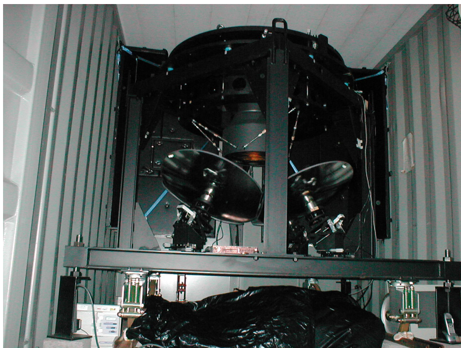
図 2.13: Baker-Nunn 光学系の 3 分の 2 試作機
