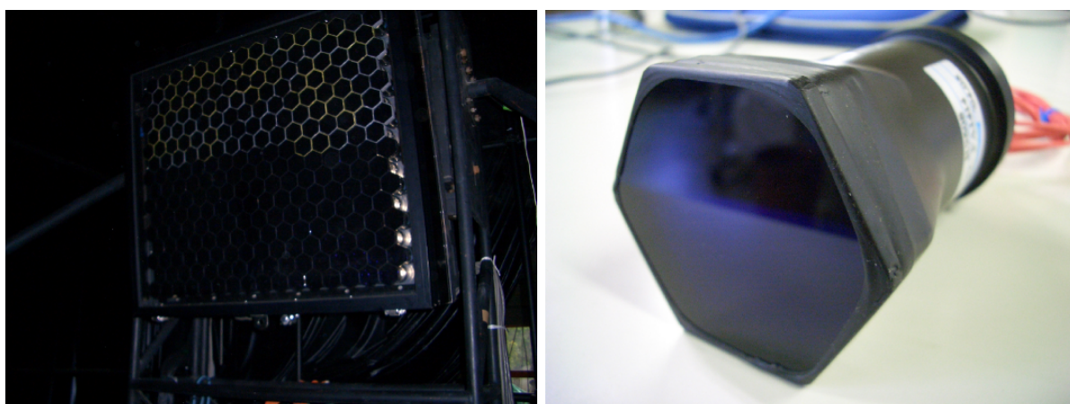
図 3.7: PMT カメラ (左) と BG3 が取り付けられた PMT (Hamamatsu, R9508)(右).
