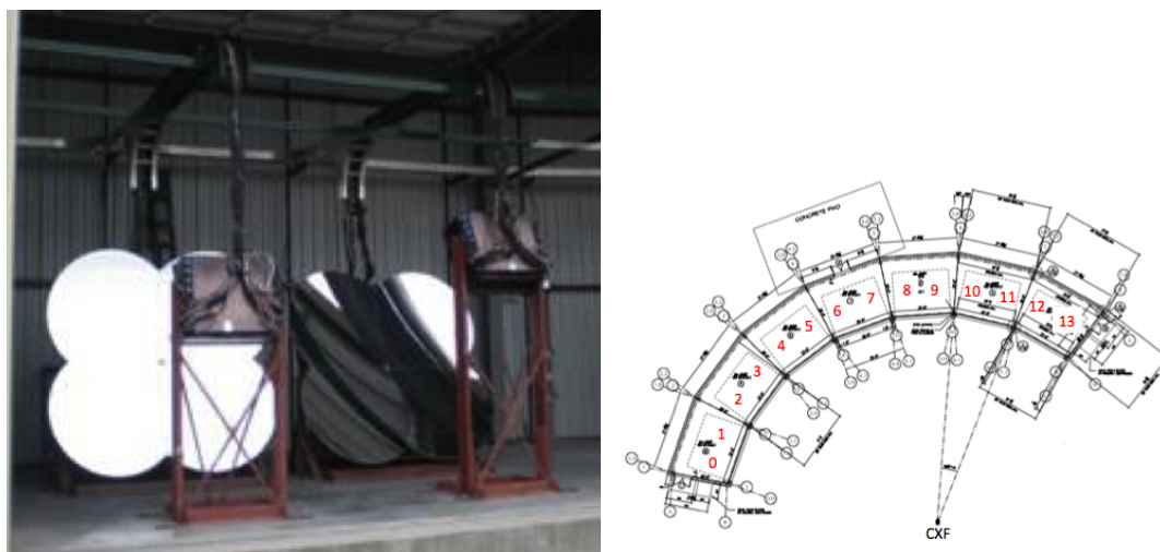
図 4.2: MD ステーションの大気蛍光望遠鏡 (左) と 各望遠鏡の ID(0 ~ 13) (右)。
