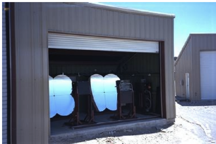
図 2.3: HiRes 実験で用いられていた大気蛍光望遠鏡。
