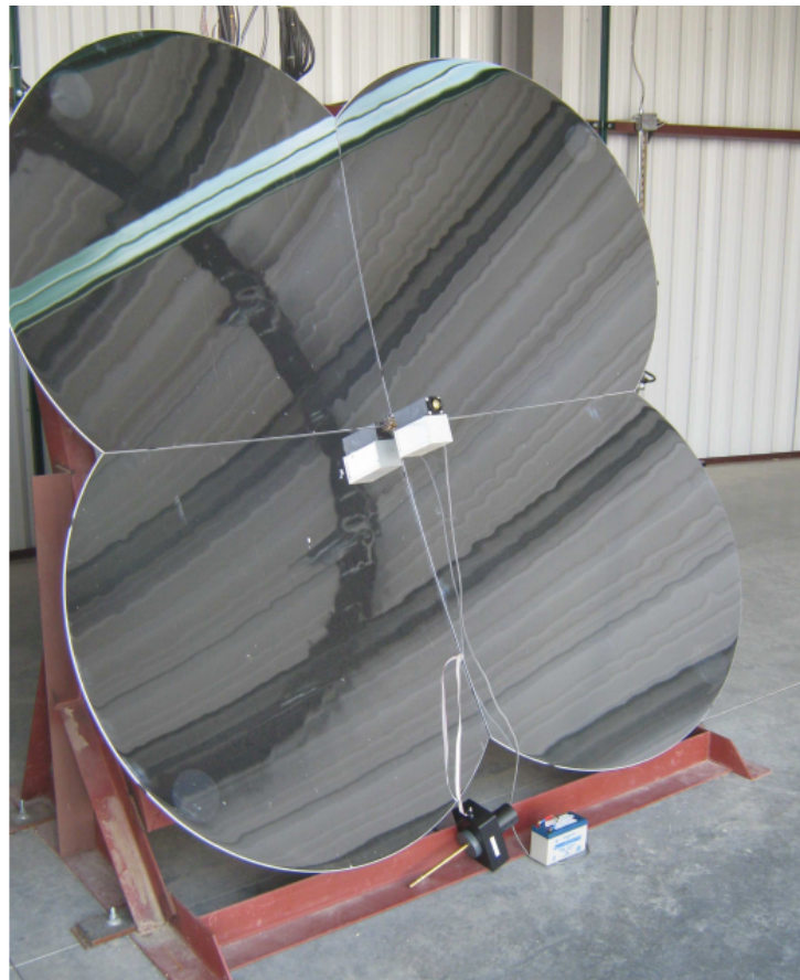
図 4.13: 球面鏡の中心に取り付けられた RXF.
