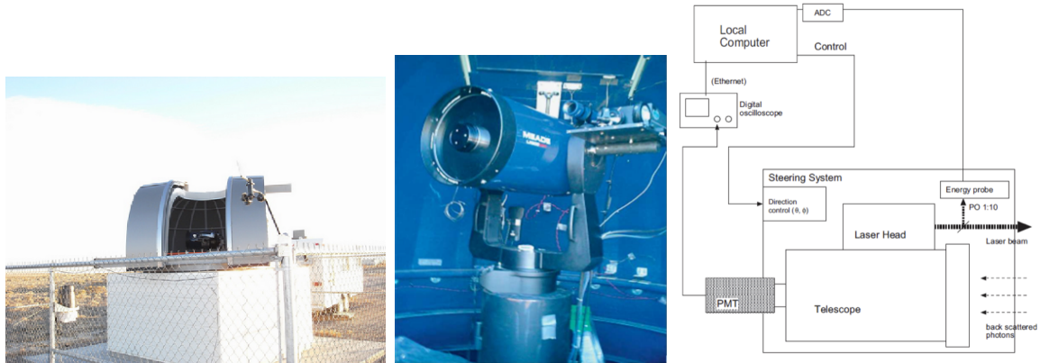
図 3.20: LIDAR ドーム (右) とドーム内部の装置 (中). ドームの中にある望遠鏡には右のようにレーザーと PMT が取り付けられている.
