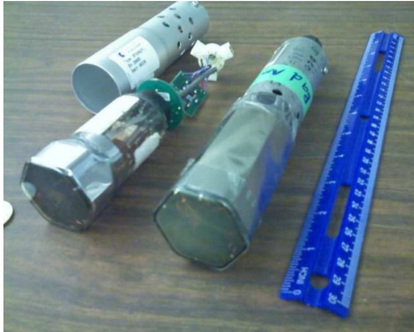
図 4.4: MD ステーションで使われている PMT. 左側の PMT はシールドが取りはずされており、プリアンプを含む小さな回路ボードが見えている。プリアンプ回路については第 4.2 節および図 4.8 を参照。
