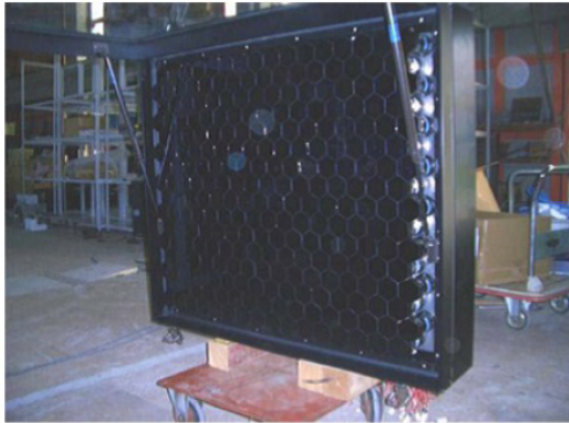
図 3.16 256 本の PMT で構成されるカメラ
