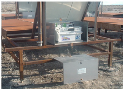
図 3.7 ソーラパネルの下の箱にはエレクトロニクスとバッテリーが格納されている。L字型の上蓋をあけた状態。
