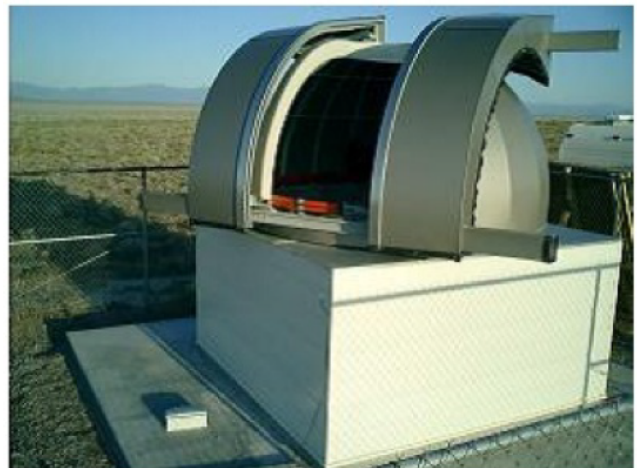
図 3.25 LIDAR ドームの外観。観測時にドームが開き 1 Hz でレーザーを打ち大気の状態を測定する。
