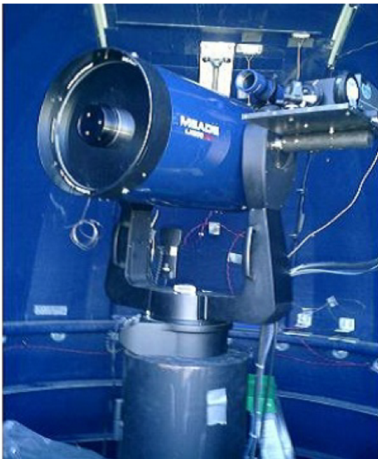
図 3.24 LIDAR システム。中央の反射型望遠鏡が広報散乱を中央に設置してある PMT に集光する。
