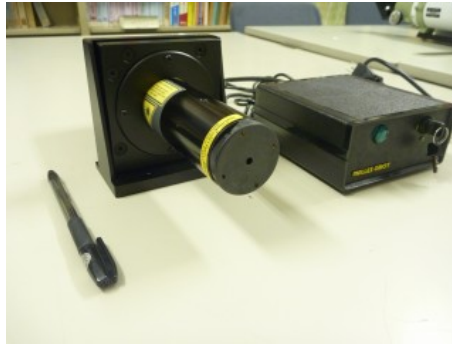
図 3.3: HeNe レーザーヘッドと円筒形レーザー用精密ホルダ (左), HeNe レーザー電源 (右)
