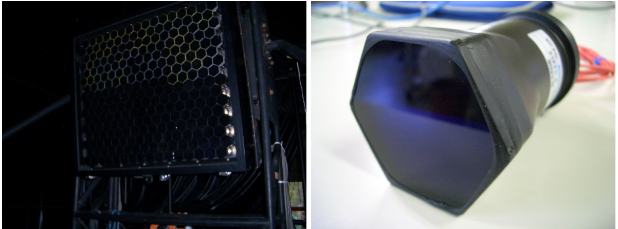
図 2.4: PMT カメラ (左) と BG3 が取り付けられた PMT(R9508)(右)
