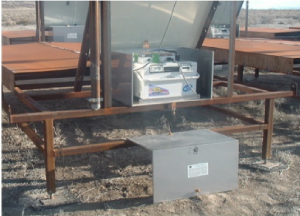
図 2.3: ソーラーパネルの下の箱にエレクトロニクスとバッテリーが収納されている。
