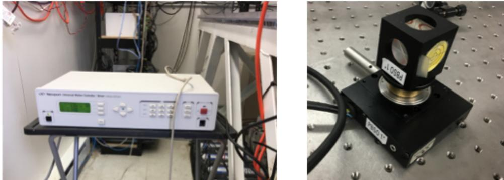
図 4.4: 脱偏光試験装置 (左:制御装置, 右:偏光プリズム + 回転子)
