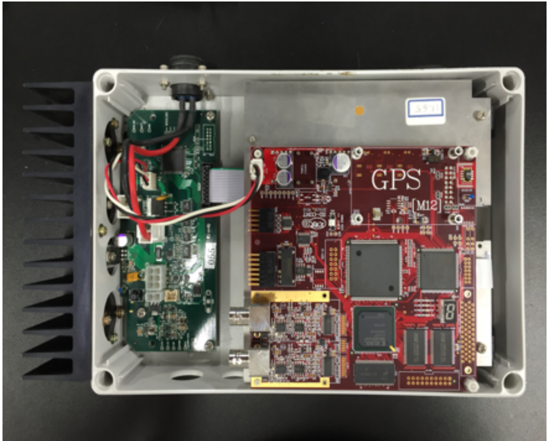
図 3.5: SD エレクトロニクスの上段部。下段部分にレッドパインを格納している。
