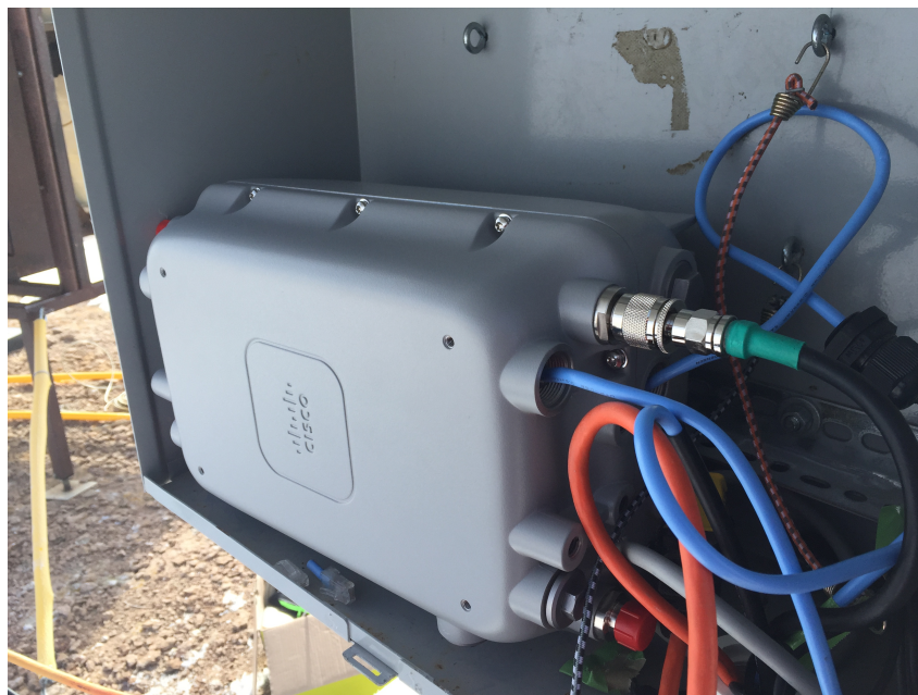
図 4.3: アクセスポイントはタワーの昇降可能な箱の中に設置される。
