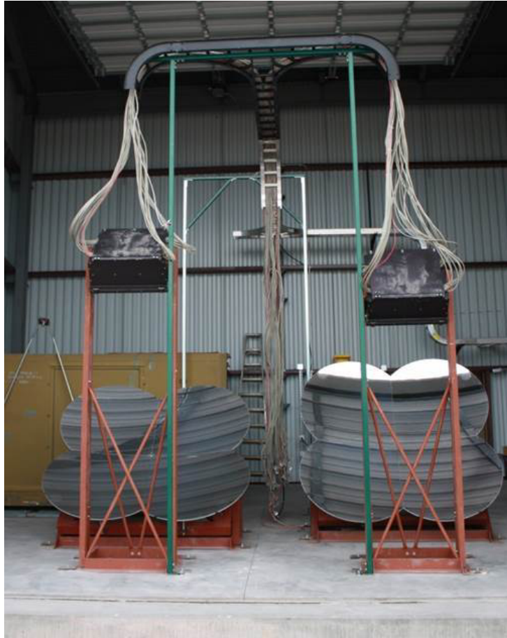
図 2.8: TALE-FD ステーションの大気蛍光望遠鏡
