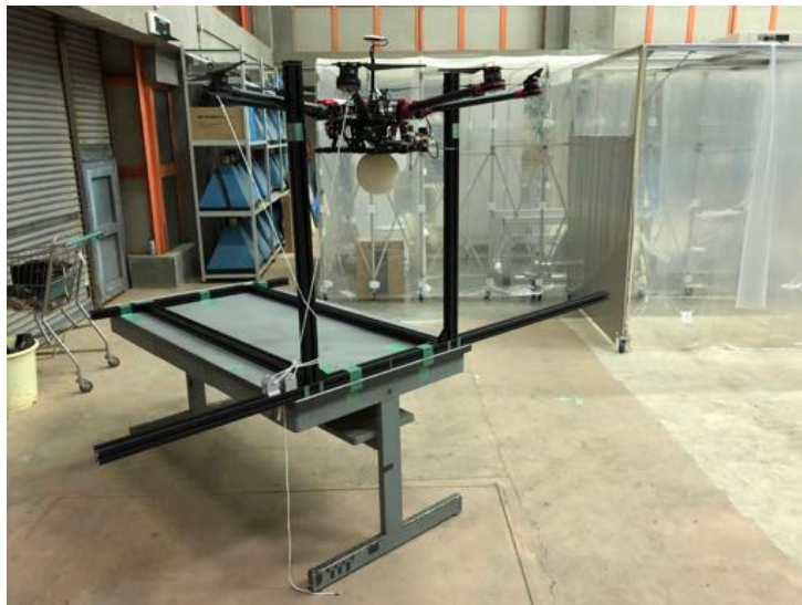
図 5.36 機体の固定方法。機体のアームを軸に、仰角方向に回転する。角度計測器を用いて角度の調節を行い、各角度での固定はロープを使用した。
