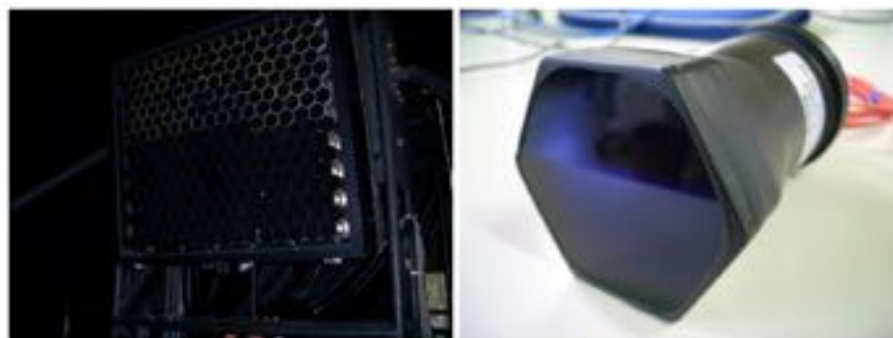
図 2.7 ハニカムアレイ状に配置された 256 本の PMT から構成されるカメラ (左) と, BG3 を取り付け PMT(浜松ホトニクス製 R9508) (右).
