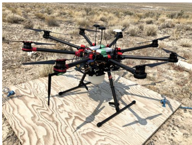
図 7.16 Opt-copter の高精度 GPS モジュールの通信アンテナの取り付け位置を変更した。これまでは機体の胴体付近に取り付けていたが、機首方向によって機体の影に隠れてしまうことからプロペラアームの先に取り付けた。
