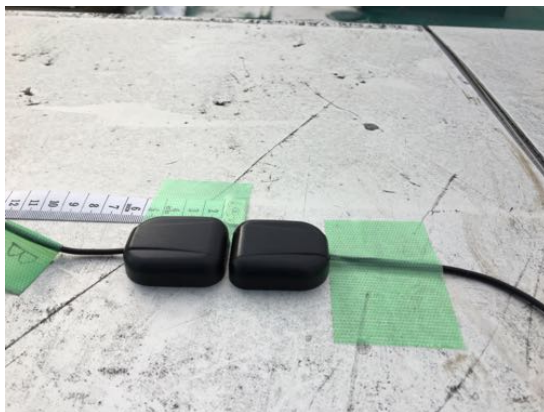
図 6.3 2 台の高精度 GPS モジュールの初期較正位置。
