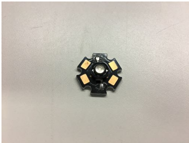
図 4.3 光源に使用した LED 「H2A1-H375」.
