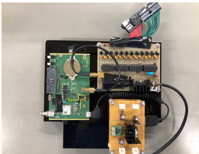
図 4.6 Opt-copter に搭載されている光源駆動回路類。右上は光源に電力を供給する回路，下はレギュレーター回路，左は GPS 信号 (1PPS) を 10PPS に変換するモジュール。
