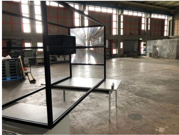
図 5.15 東京大学宇宙線研究所明野観測所の倉庫内の様子。手前に望遠鏡，奥に光源が設置されている。地面の反射が影響しないように，望遠鏡と光源を机の上に設置した。
