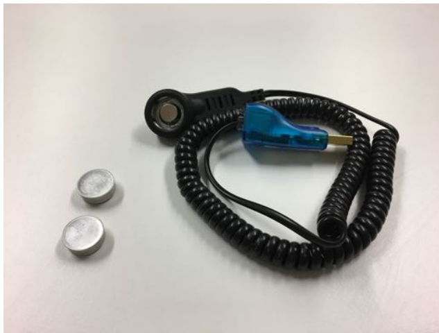
図 4.7 温度ロガーの外観。ボタン型温度ロガー（左）と、温度データを回収する際に使われる専用ケーブル（右）。
