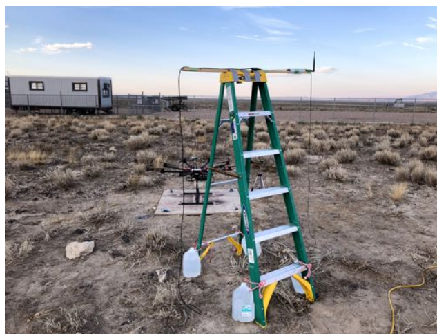
図 7.15 基地局側の高精度 GPS モジュールの通信アンテナの取り付け位置を変更した。これまでは作業机の上に取り付けていたが、Opt-copter の飛行位置によって建物やフェンスが通信に影響することから脚立の上に取り付けた。
