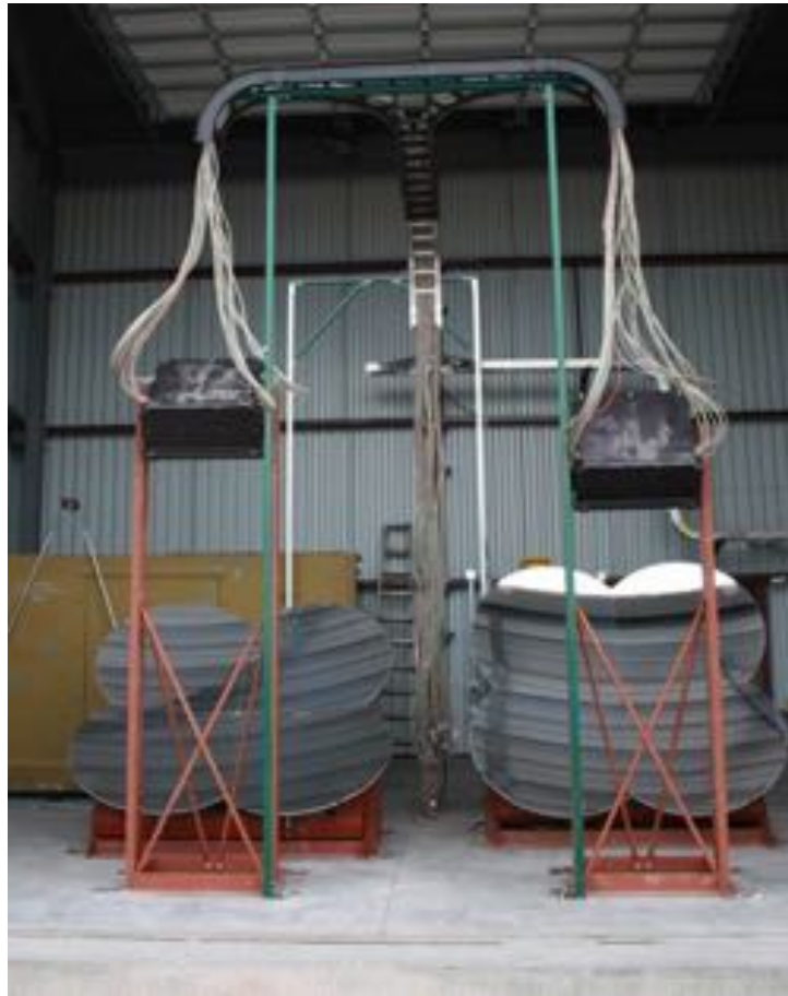
図 2.9: TALE 実験 FD ステーションの大気蛍光望遠鏡
