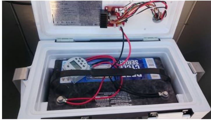
図 6.7: TALE 実験 SD のバッテリー部分に装備されたリブートタイマー
