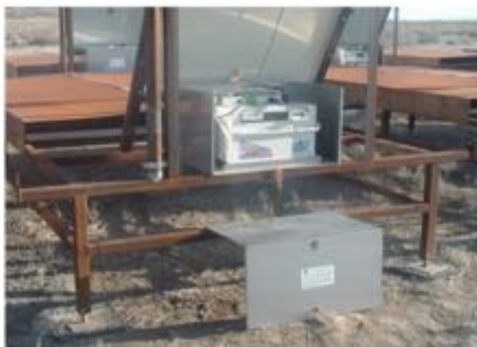
図 2.11: ソーラーパネルの裏の箱に SD エレクトロニクスとバッテリーが格納されている。
