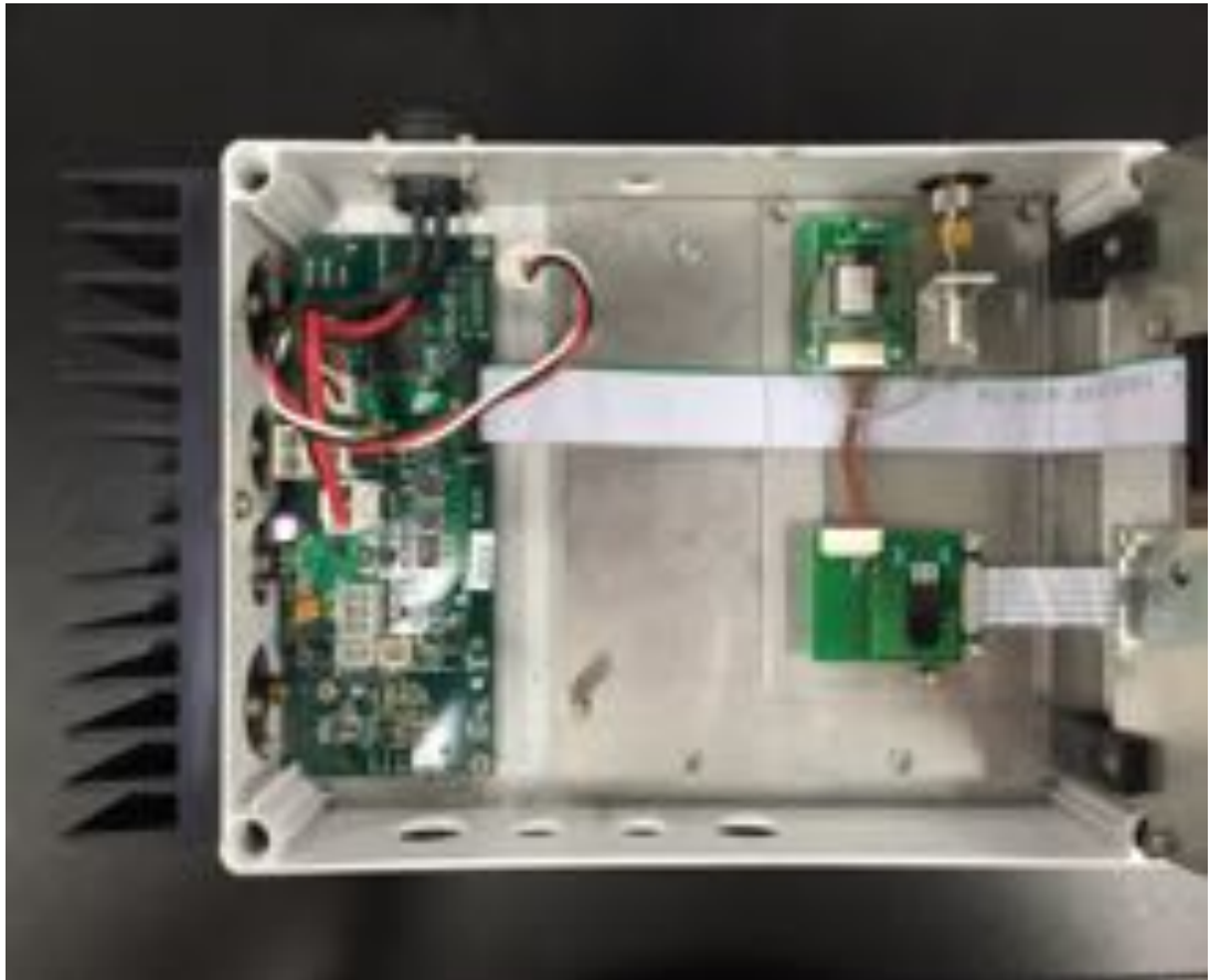
図 3.6: SD エレクトロニクスの下段部。RS モジュールを格納している。
