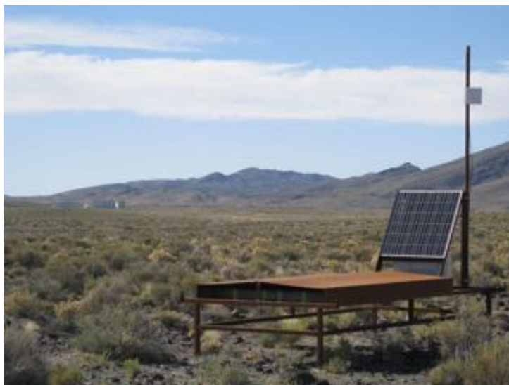
図 2.10: 現在設置されている TALE 実験 SD。茶色の屋根の下にシンチレータボックスが格納されている。
