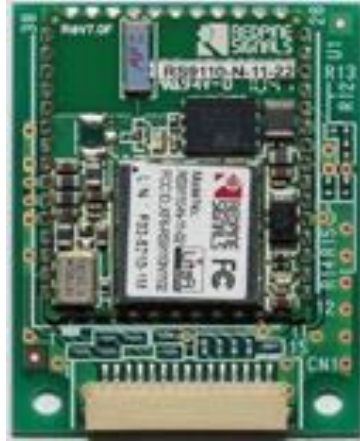
図 3.2: Redpine Signals 社製無線 LAN モジュール RS9110-N-11-02
