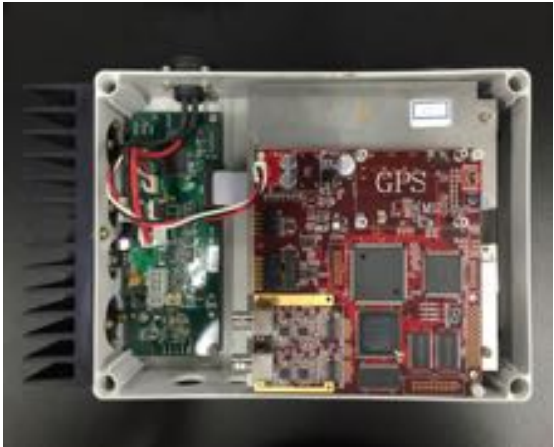
図 3.5: SD エレクトロニクスの上段部。下段部分に RS モジュールを格納している。
