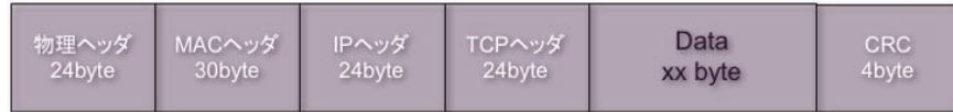
図 3.3: RS モジュールのデータユニット。Data の部分には最大で 1000 Byte のデータを入れることができる。
