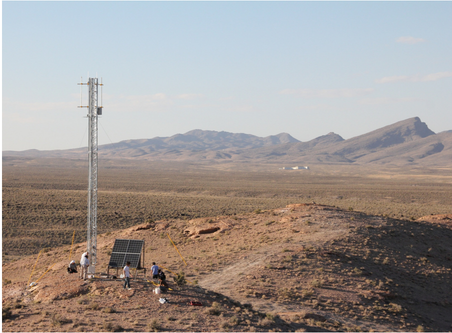
図 2.8: TALE 実験用のデータ通信塔の外観 (MDCT)。電力源は太陽光パネルによる発電である。中央の右奥に MD/TALE-FD ステーションがある。
