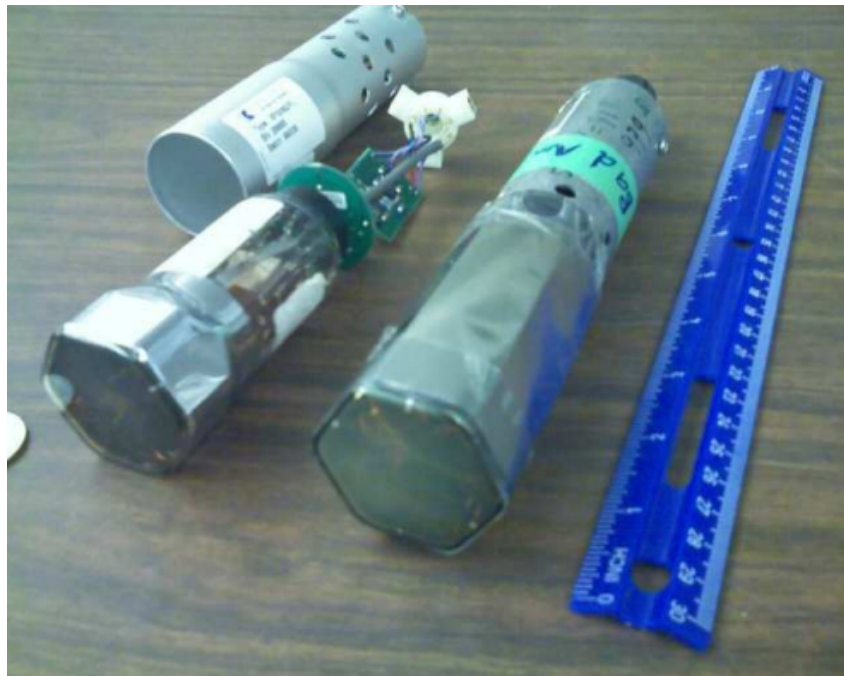
図 3.4: MD ステーションで使われている PMT. 左側の PMT はシールドが取り外されており, プリアンプを含む小さい回路が見える.
