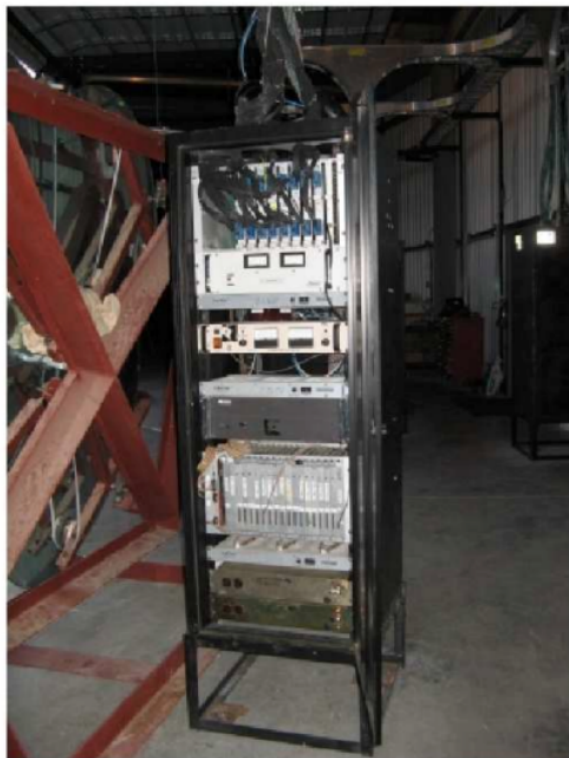
図 3.6: MD ステーションで使用されているエレクトロニクスクレートと概略図 .
