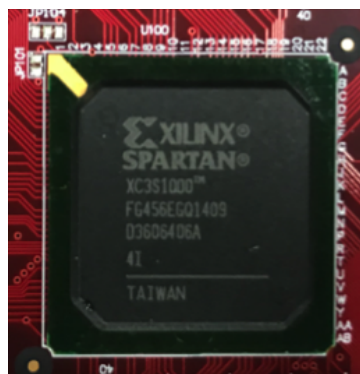
図 4.16: SD エレクトロニクスで使用されている FPGA。Xilinx 社製 XC3S1000
