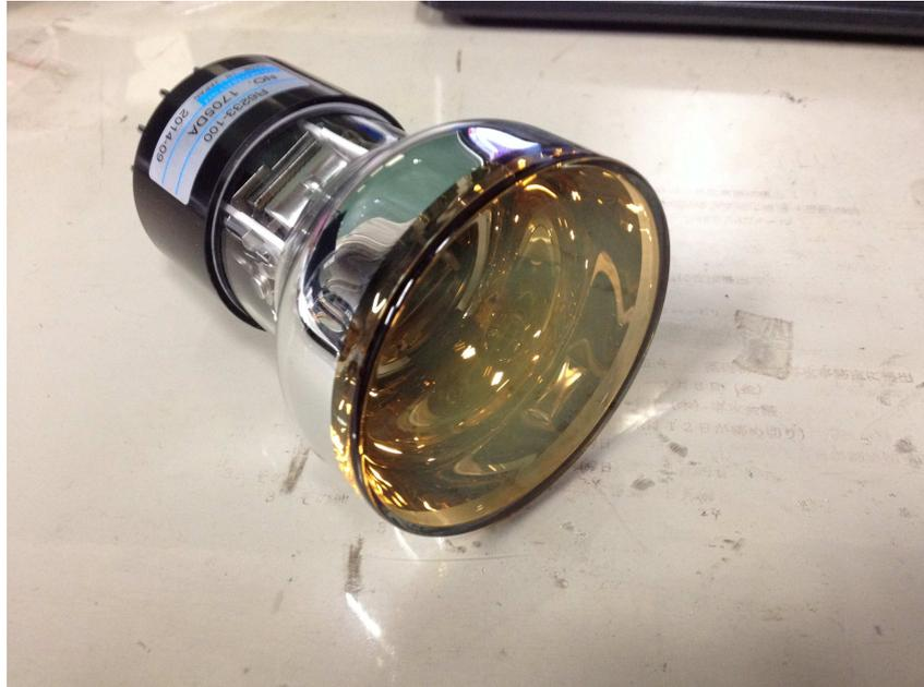
図 4.8: PMT 写真：受光面の直径は 70mm。
