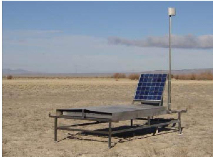
図 3.6: 現在設置されている TA 実験 SD。茶色の屋根の下にシンチレータボックスが格納されている。
