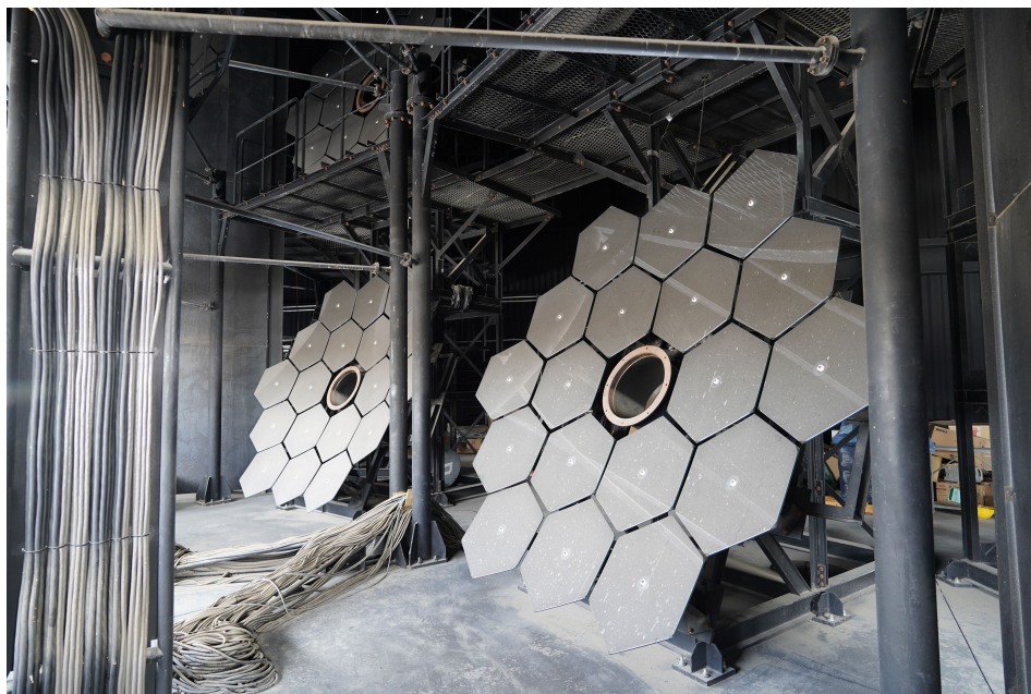
図 2.5: BRM ステーションに設置されている鏡の写真 (撮影 Y. Kawachi)
