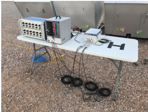
図 3.24 設置されたエレクトロニクス。左から、High Voltage Distributor, NIM ビン電源, FADC ボード。
