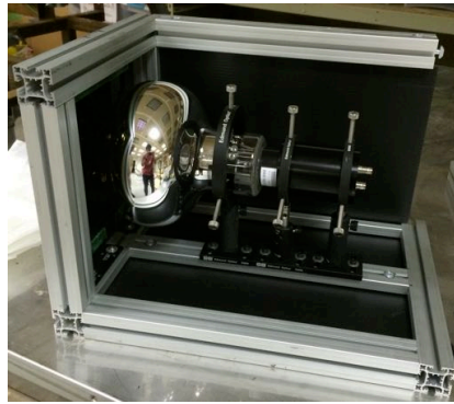
図 2.9 光電子増倍管を PMT 架台に設置した様子
