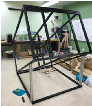
図 3.9 組み立てたアルミフレーム
