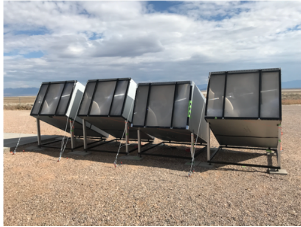
図 3.15 設置が完了した 4 台の新型望遠鏡. 一番右から, Tel.#1, Tel.#2, Tel.#3, Tel.#4 と呼ぶ.
