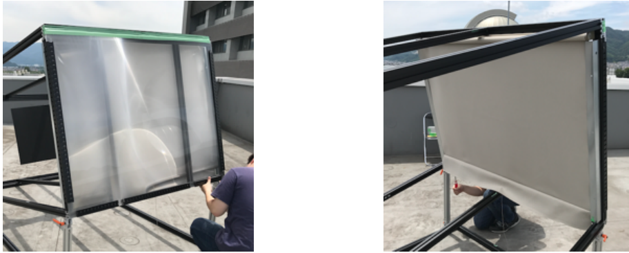
図 3.2 ロールカーテンによる遮光の様子。右図のロールカーテンの左右についているアルミパーツはロールカーテンをレンズに沿わせるためのアルミチャンネルで、ロールカーテンのウェイトバーがアルミチャンネルの溝に沿って動く。
