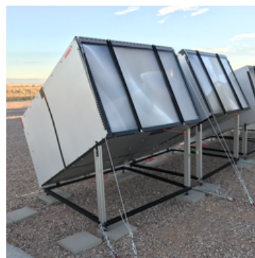
図 3.14 ワイヤーとペグによる望遠鏡固定の様子
