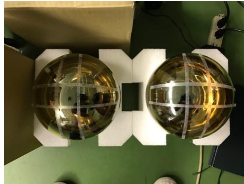
図 2.20 メンディングテープで感面中央付近に目印をつけた光電子増倍管
