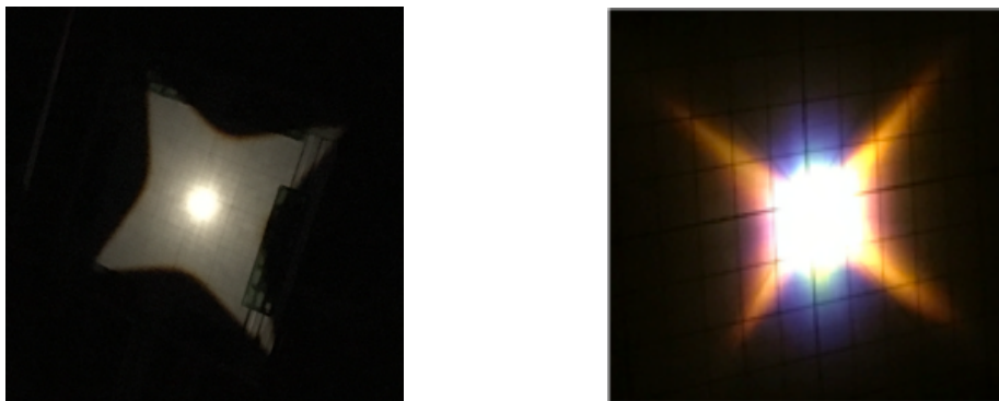
図 3.1 左が従来の正方形レンズで月光を集光した様子，右が新しい長方形レンズで街灯の光を集光した様子。
