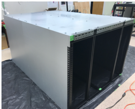
図 3.11 ガルバリウム鋼板を固定した望遠鏡
