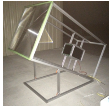
図 2.13 組み上げたプロトタイプ望遠鏡。観測時は側面をシート等で遮光する。
