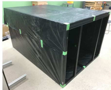
図 3.10 黒いプラシートを巻いた望遠鏡
