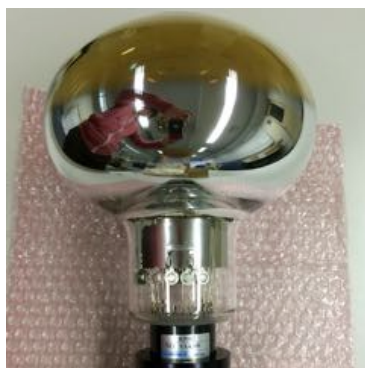
図 2.5 光電子増倍管 (R5912)
