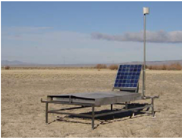
図 3.22: 現地に設置されたシンチレーション検出器
