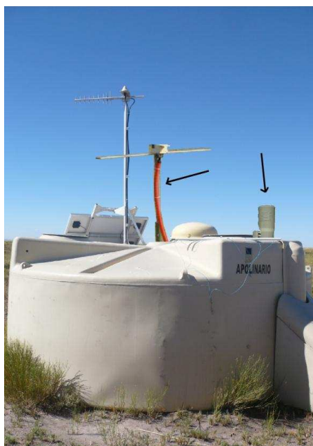
図 2.5: Auger 実験の地表検出器の上に取り付けられた、EASIER アンテナ試作機 (矢印で示されている)。
