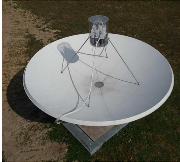
図 2.2: CROME にて用いられている C バンドアンテナ。dish には、分割パラボラアンテナ Prodelin 1344 (直径 335 cm、焦点距離 119 cm) が用いられている。また、カメラには、9ch いずれも、C-band 用直線偏光 LNB Norsat 8215F が用いられている。
