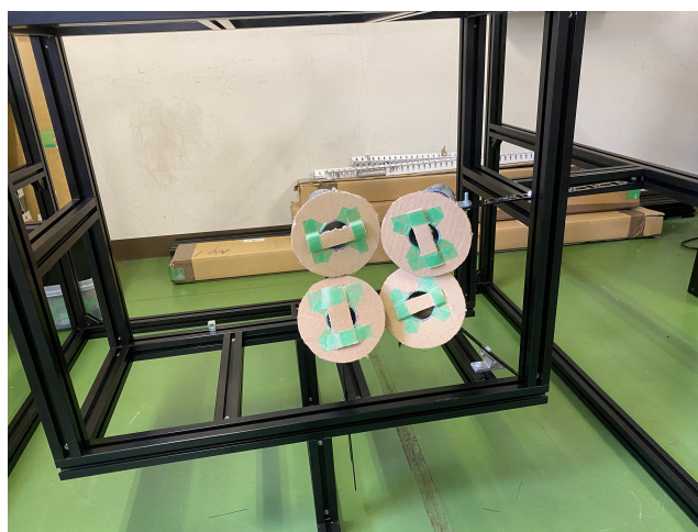
図 4.3: 作成した 4 本分の固定マウント。マウントしているのはプラスチックのダミー。
