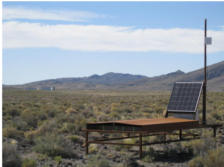
図 2.8: 現地に設置された TALE-SD. 左奥に MD/TALE-FD ステーションが見える.
