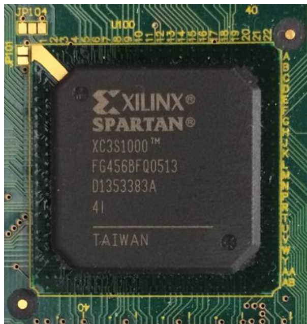
図 3.4: エレクトロニクスで使用されている FPGA, Xilinx 社製 XC3S1000.
