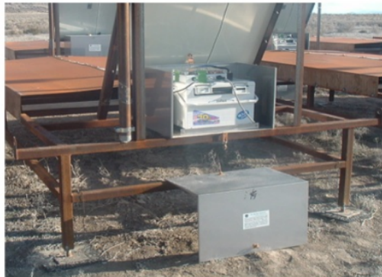
図 2.10: ソーラーパネルの下に箱にエレクトロニクスとバッテリーが収納されている。
