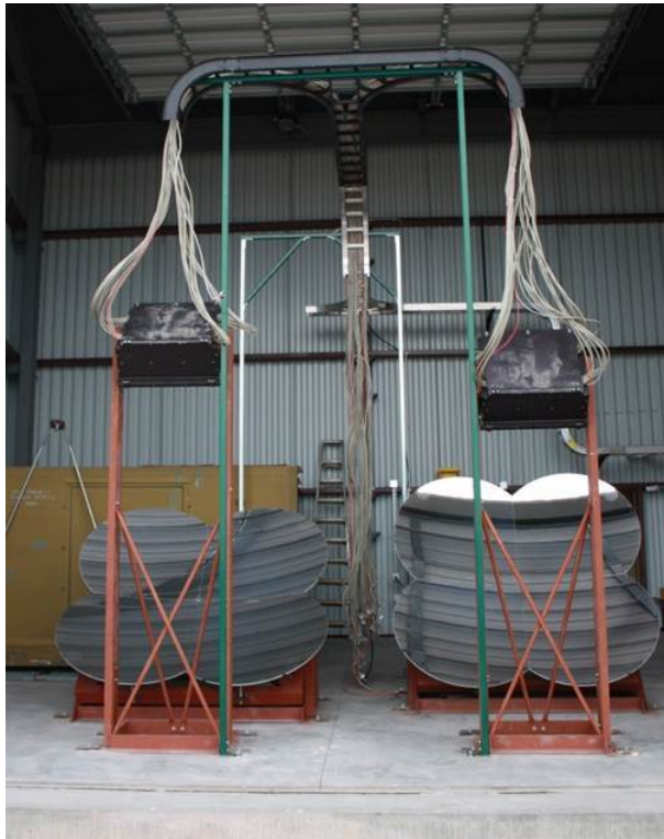
図 2.7: TALE ステーションの大気蛍光望遠鏡.
