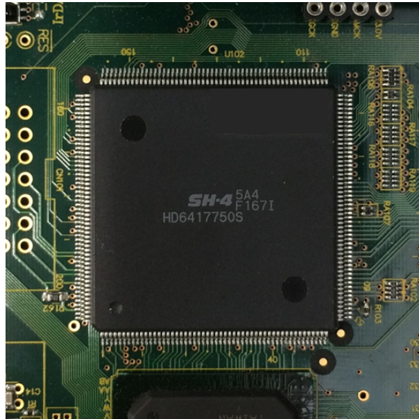
図 3.2: TALE 実験用 SD で使用する CPU(TA 実験と同様)。ルネサステクノロジ社製 SH4 マイコン SH7750S.
