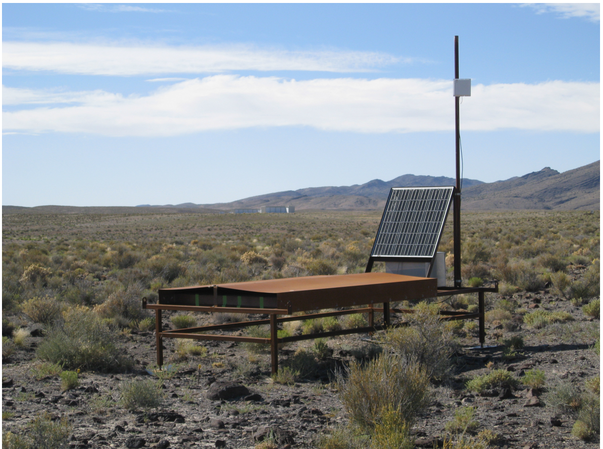
図 2.6: 現地に設置された TALE-SD。左奥に見えるのが MD/TALE-FD ステーションである。
