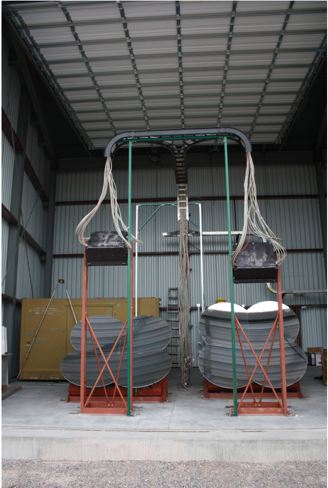
図 2.4: TALE-FD に用いられている大気蛍光望遠鏡。
