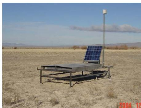
図 3.3: TA 地上検出器。ソーラーパネルで発電する。通信は無線で行う。
