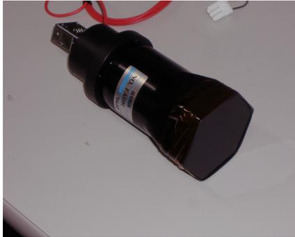
図 3.15: HPK 製 R9508。受光部の前面に BG3 フィルターが取り付けられている。
