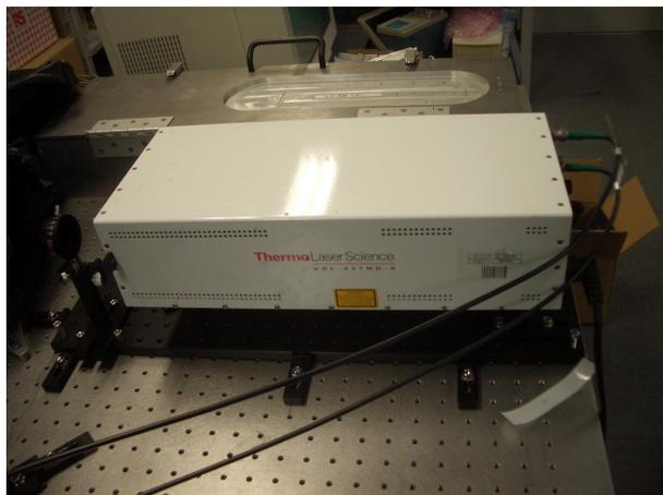
図 4.3: 窒素ガスレーザー
