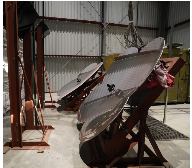
図 2.13: TALE-FD の側面図。奥が高仰角、手前が低仰角を観測する望遠鏡である。図中左上に PMT からなるカメラ、右に鏡がある。
