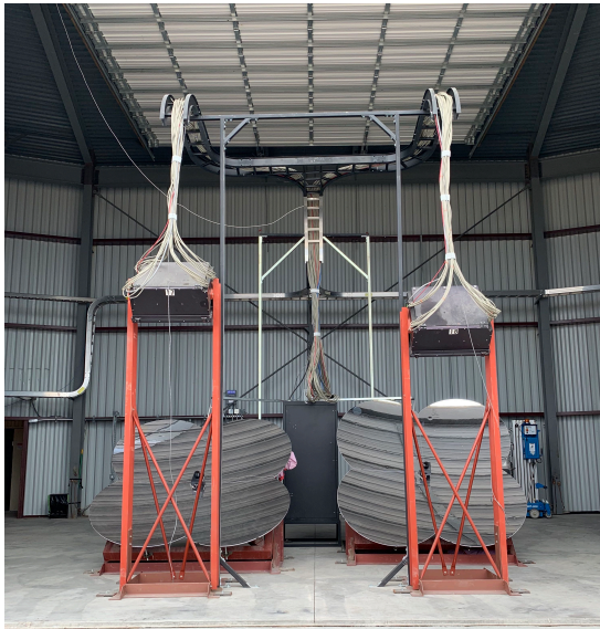
図 2.12: TALE-FD の正面図 [38]。図中左が高仰角（仰角 31^\circ から 59^\circ ）、右が低仰角（ 31^\circ から 45^\circ ）を観測する望遠鏡である
