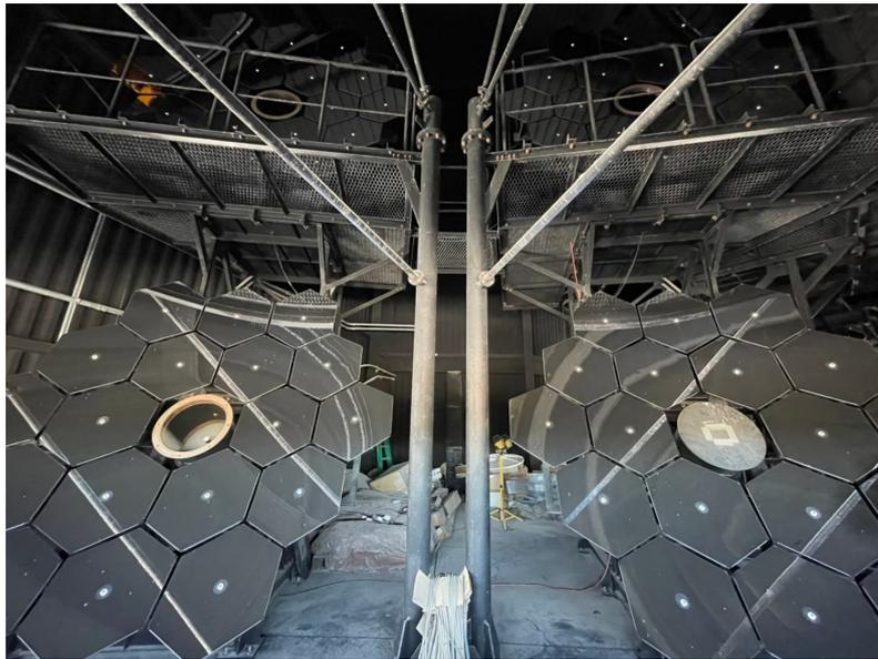
FIGURE 4.2. TA FD: テレスコプアレイ実験大気蛍光望遠鏡の一部。画像はBRMステーションにある上下6台ずつ、12台の望遠鏡のうちの4台を撮影したもの。著者撮影。
