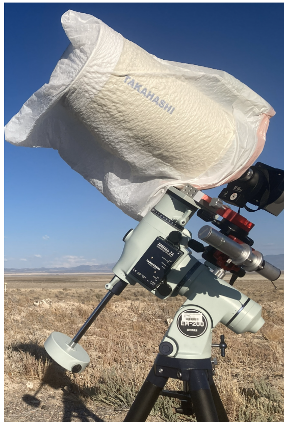
図 3.3: 試験観測で使用した実験装置全体像。観測開始前、望遠鏡保護のために鏡筒部分にビニール袋をかぶせている。
