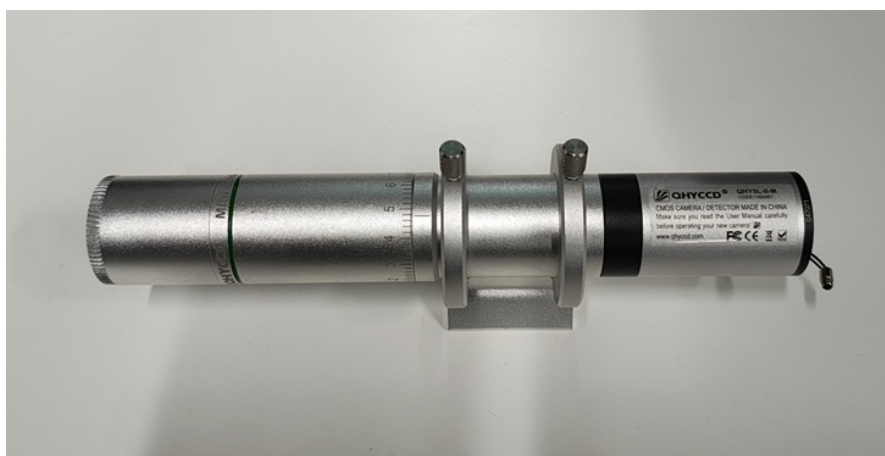
図 3.8: ガイダーの外観。製品シールが貼ってある部分が QHY5L-II-M カメラ、アリガタのマウントが取り付けられている銀色の筒部分が miniGuideScope である。
