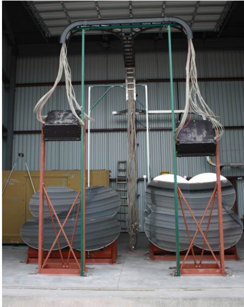
図 2.9: TALE 実験 FD ステーションの大気蛍光望遠鏡。左は上視野望遠鏡で右は下視野望遠鏡である。PMT カメラは黒色のボックスの中に 256 本敷き詰められている。
