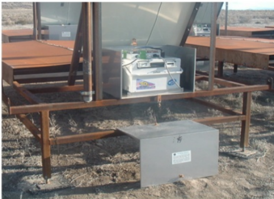
図 2.29: ソーラーパネルの裏の箱に SD エレクトロニクスとバッテリーが格納されている（エレクトロニクス格納箱のふたを外したところ）。
