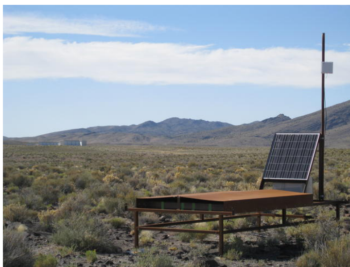
図 2.27: TALE-SD の外観。茶色の屋根の下にシンチレータボックスが格納されている。写真中央左寄り遠くに MD ステーション、TALE-FD ステーションが見える。
