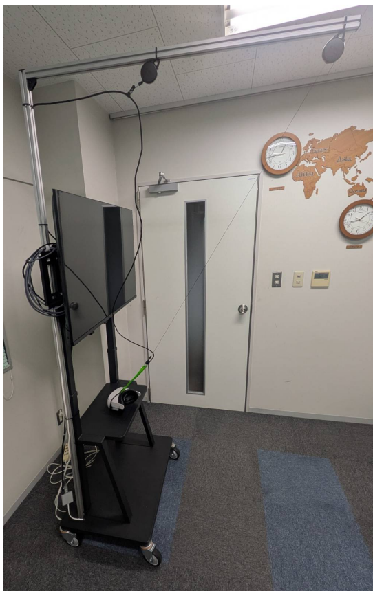
図 4.3 上方からの安定給電を実現するフレームとディスプレイスタンドの構成
