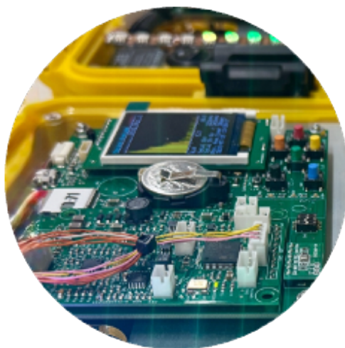
図 5.15 雷雲プロジェクトの放射線検出器
