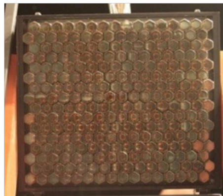
図 3.3: 使用している PMT とカメラボックスの外観.
