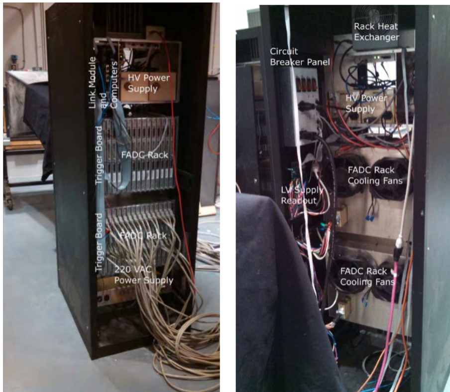
図 3.4: TA x 4 の FADC エレクトロニクスラックの正面と背面の写真。
