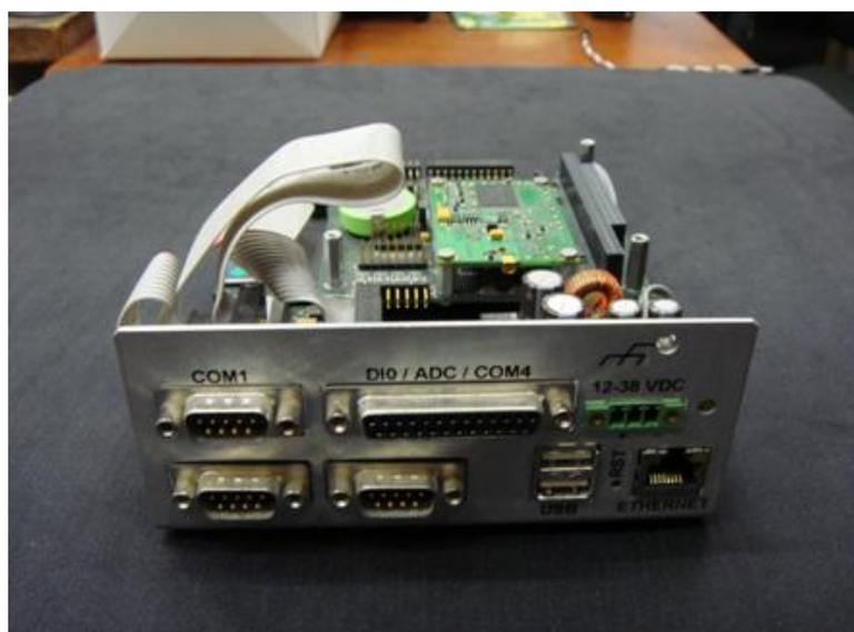
図 4-10 GPSy を搭載したボード型パソコン
