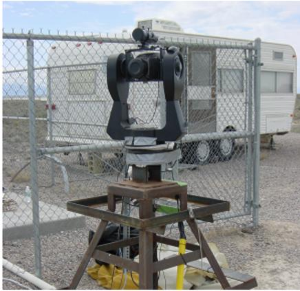
図 2-14 IR カメラの外観
