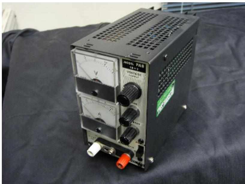
図 4-11 DC 型可変直流電源(PAB 18-1)
