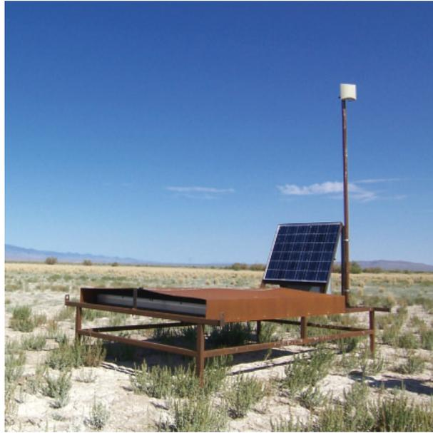
図 3.15: 現地に設置されたシンチレーション検出器
