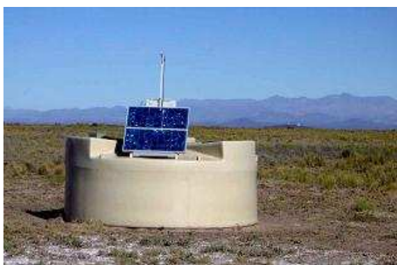
図 2.4: Auger 地表検出器の外観
