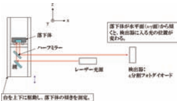
図3：角速度測定実験のセットアップ
