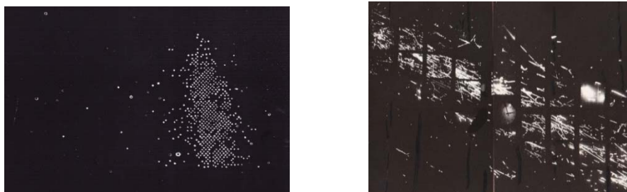
図 3-9 ネオンホドスコープで観測された「ぞうりむし」状の現象(左)とスパークチェンバーによる「水平シャワー」(右)の例 127
