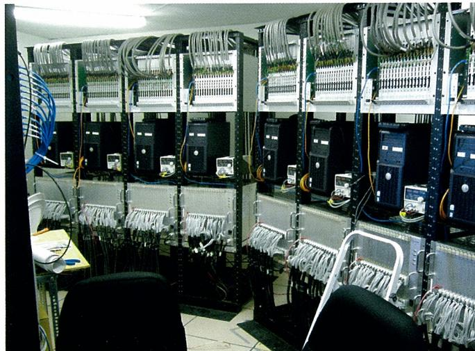
各ステーションには、データ収集用のエレクトロニクスを設置した回路室があります。ここでは、光電子増倍管3,072本からの信号をデジタル情報へ変換し、FPGA回路を駆使して高速で安定したイベント判定を行っています。また、光電子増倍管に印加する高電圧を制御したり、各種較正用装置の制御や環境データ取得を行っています。各観測期間（月のない晴天夜）に取得されるデータ量は約1TBに達し、宇宙線研究所とユタ大学に持ち帰っています。
