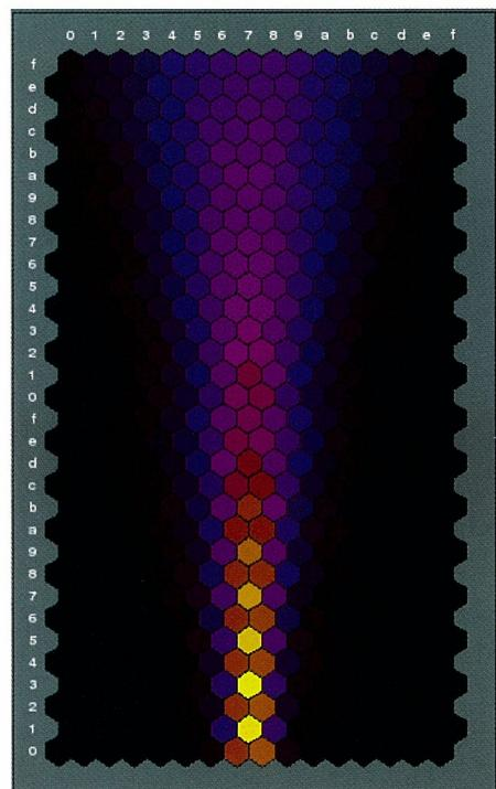
LINAC によって生成された空気シャワーを大気蛍光望遠鏡で観測した時のシミュレーションで、実際に観測されるデータとの比較から装置を較正することができます。
