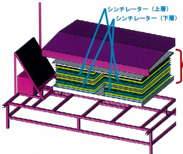
地上検出器は  $3.0\text{m}^2$  の大きさで 12mm 厚のシンチレータ 2 層からなり、空気シャワー中の電子などの荷電粒子を検出します。環境放射線によるノイズの混入は独立したシステムでは大きな問題となりますですが、上下 2 層の同時入射という条件を課すことで、"信号" を選択的に取得してこの問題をクリアしています。信号処理や検出器の制御を行うエレクトロニクスは、太陽電池パネルの日陰にバッテリと一緒に収納されています。
