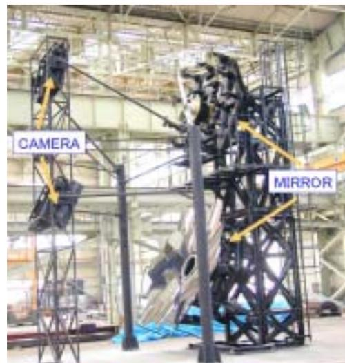
図14 望遠鏡プロトタイプ
