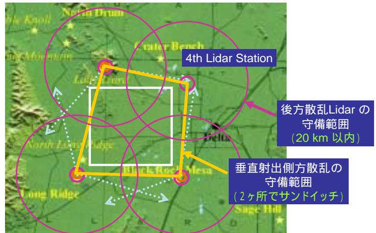
図22 大気透明度測定用レーザーの配置案
