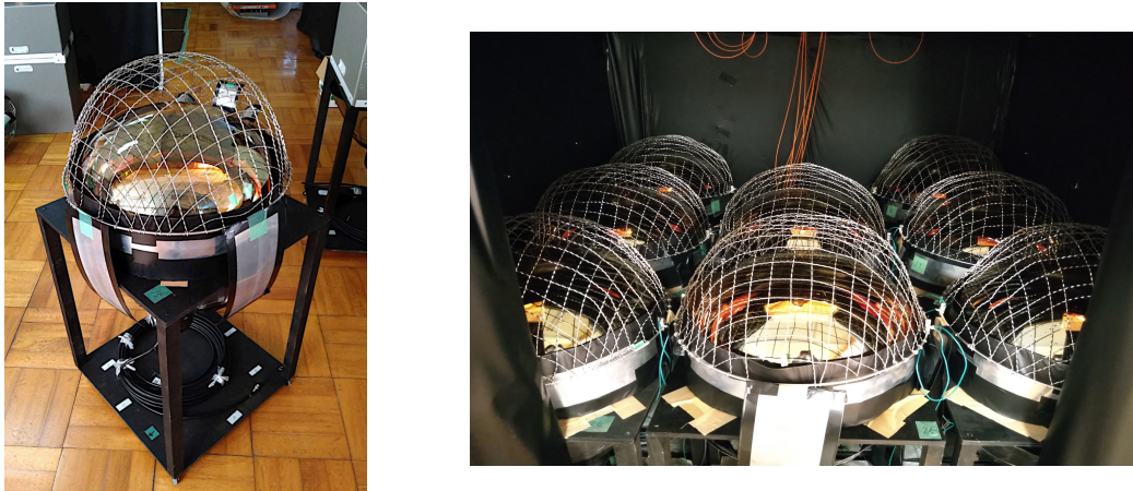
図 43 左: 磁場削減対策後の \mu -metal セットアップ。右: 暗室内部のセットアップ
