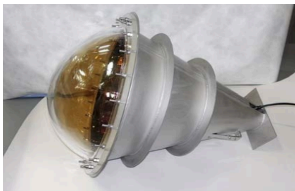
図10 アクリルカバーとステンレスカバーを取り付けた状態での PMT。
