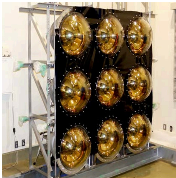
図9 PMT 架構への PMT の取り付け状態。PMT 間にブラックシートが取り付けられている。
