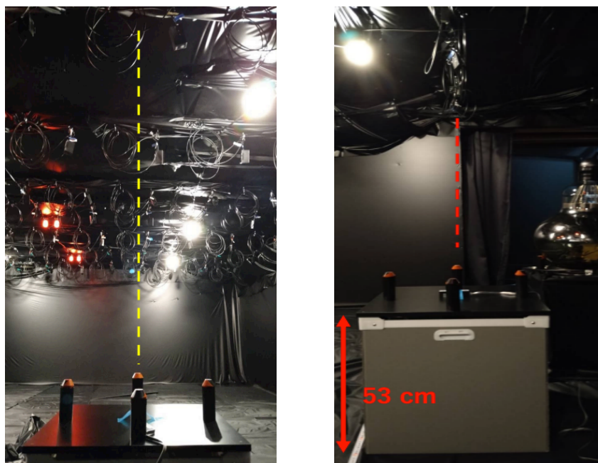
図 81 ガウスメータの設置の様子。左: 正面からの設置位置、右: 横方向からの設置位置。点線が中央の位置を表している。
