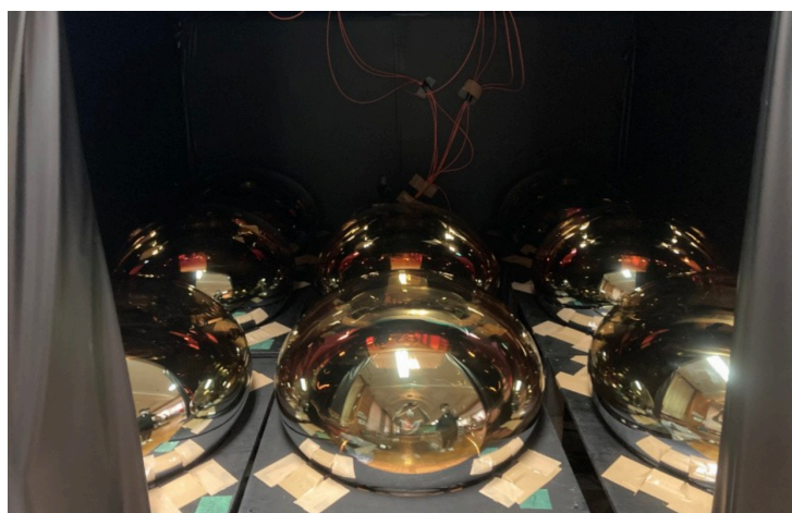
図 36 長期測定の測定の暗室内における PMT インストール時のセットアップ。
