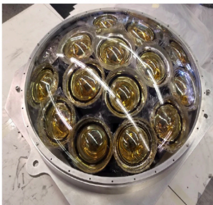
図6 左: Multi-PMT、右: Multi-PMT 内部の構造。
