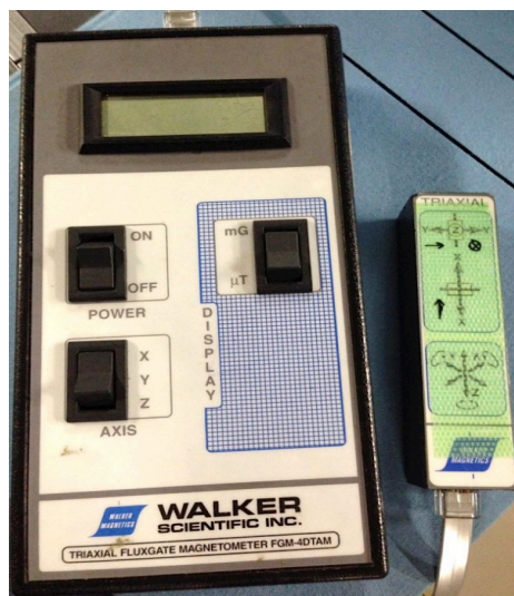
図 41 磁場測定器、TRIAXIAL FLUXGATE MAGNETOMETER FGM-4DTAM。
