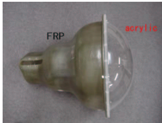
図 2.12: 衝撃波防止ケース：FRP とアクリルで構成され、衝撃波が起きないように設計がなされている。
