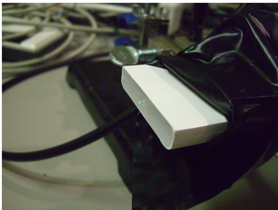
図 5.9: PMT に接続されていない側のシンチレータ端面の様子。緑色の管が、ファイバーである。テスト 1 では、なにも処理を施してはいない。
