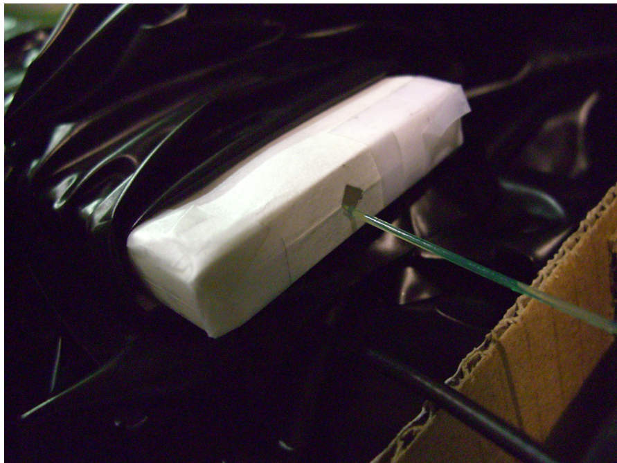
図 5.18: PMT と接続されている側のシンチレータ端面にタイベックシートを付けたときの様子。
