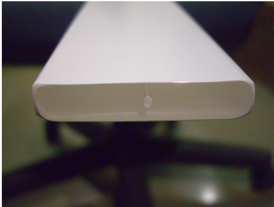
図 5.19: シンチレータ端面を紙ヤスリで研磨した時の様子。
