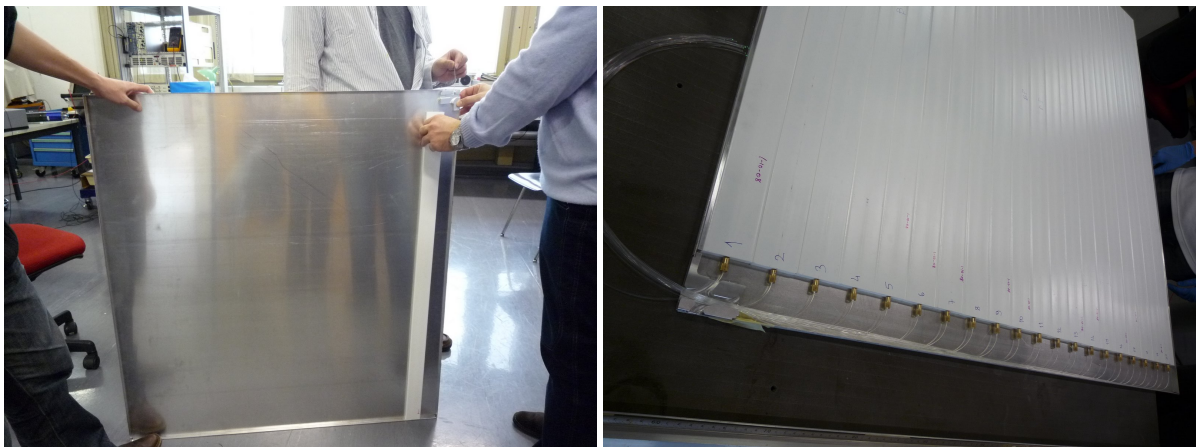
図 5.25: カウンタープレーン。写真左は、アルミニウム製のカウンタープレーン用のボックス。写真右は、そのボックスに 20 本のシンチレータストリップを敷き詰め、ストリップに波長変換ファイバーをセットしたときの様子。
