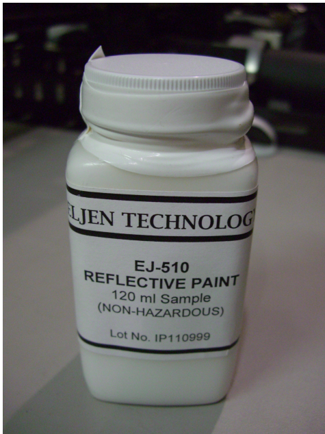
図 5.15: 左の写真は、テスト実験に用いた反射材 (ELGEN Technology 製 EJ-510)。右図は、反射材の各波長に対する反射率を表している。
