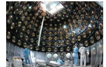
Inside the 200ton tank of the test facility for SK-Gd project SK-Gd計画の実証実験のための200トンテストタンク
