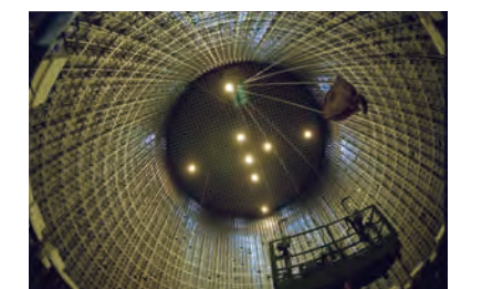
Inner detector after removing all PMTs after the accident PMT 破損事故後全ての光電子増倍管が取り除かれた検出器内部
