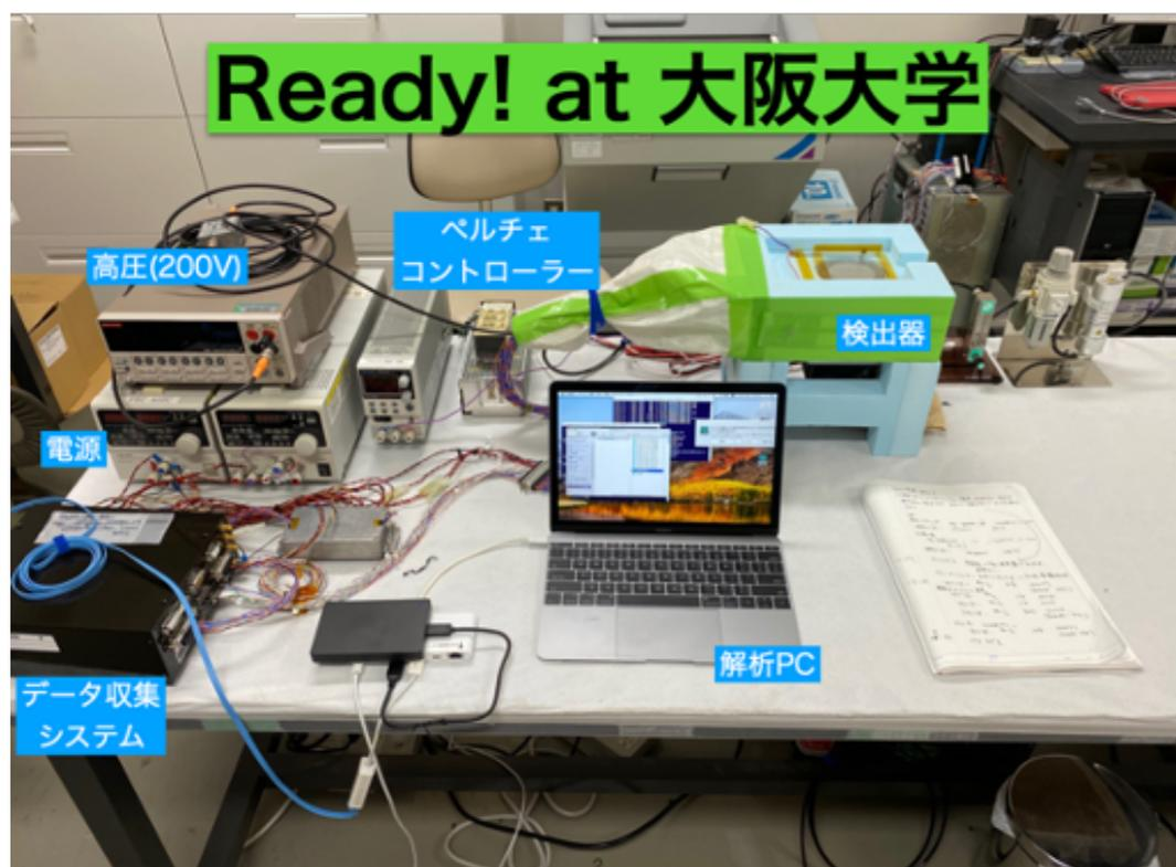
ひとみ衛星搭載 CdTe-DSD検出器
