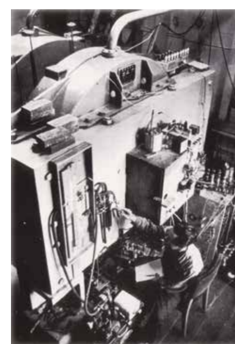
大型電子磁石と霧箱の撮影装置 (1956 年)
