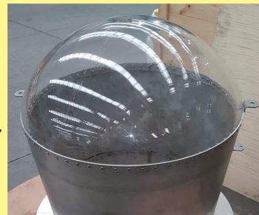
スペインで開発中の防爆 ケース。大事な光セン サーを守る役割を持つ
