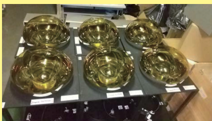
国内で生産が急ピッチで 進められる直径 50cm の 光電子増倍管
