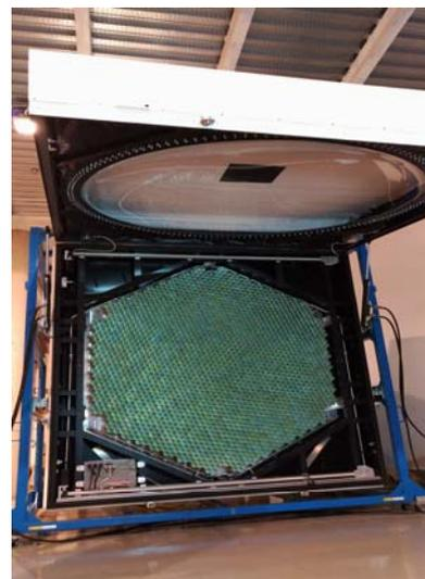
図 1、大口径望遠鏡に搭載されたカメラ。1855 個の PMT を搭載している。
