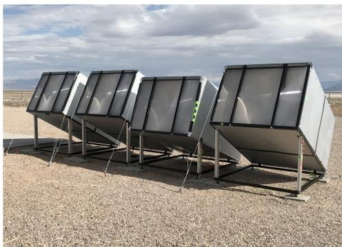
図1：設置したCRAFFT望遠鏡の外観図
