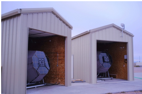
図 1: テレスコプアレイ観測サイトに設置した、2 基の新型大気蛍光望遠鏡
