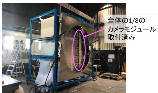
図4：スペイン CIEMAT 研究所にて、初号機カメラの動作試験。
