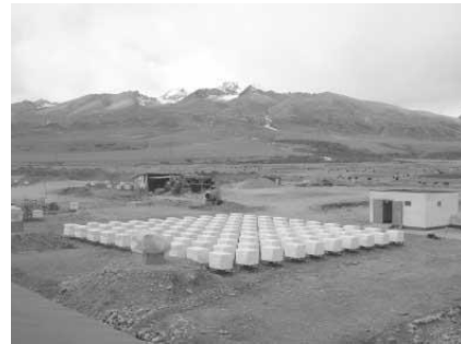
図 1 Tibet III アレイの中心に設置した YAC-II アレイ (124 台の検出器から成る)。
