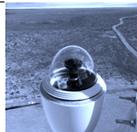
図 1: TA 実験で使用する夜天観測用の CCD カメラ
