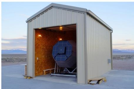
図 1: アメリカ ユタ州の TA サイトに設置された新型大気蛍光望遠鏡
