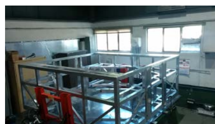
図 4、制作中のカメラボックス。CIEMAT 研究所で制作されている。これらの制作とテストが終わったら IAC にある実験室に移送しカメラ全体の組み立てとテストを行う。
