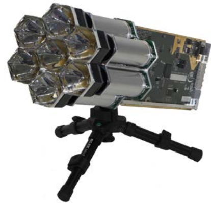
図 1、PMT モジュール。7 つの PMT に Light Guide を取り付け、それに読み出し回路を付けている。265 個の PMT モジュール、すなわち 1855 個の PMT により焦点面検出器が構成されている。
