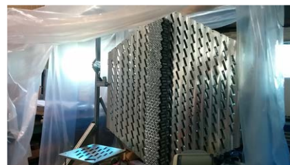
図 3、カメラ筐体に 35 個の PMT モジュールを縦に装着した写真。マドリードにある CIEMAT 研究所でテストを行った。
